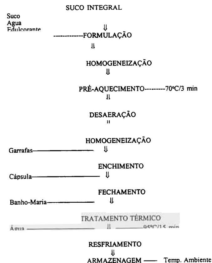
FIGURA 1 - Fluxograma do processamento de bebida dietética de caju ( Anacardium occidentale , L.)
