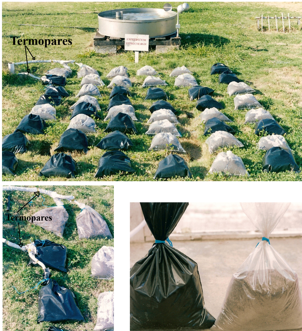
Figura 1 – a) Solarização do solo infestados em sacos plásticos pretos e transparentes monitorados com o auxílio de termopares; b) detalhe dos sacos transparentes e pretos com os termopares (setas); c) detalhe dos sacos contendo o solo. Fortaleza-CE, 2003.
