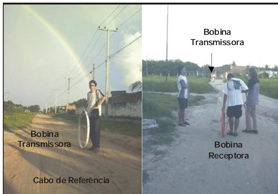
*Fig. 6 - Modo de operação no campo do instrumento EM34-3 XL. À esquerda, bobina transmissora e à direita, bobina receptora, ambas posicionadas em modo Dipolo Horizontal próximo ao PT-01/90, no Perfil L1.*
